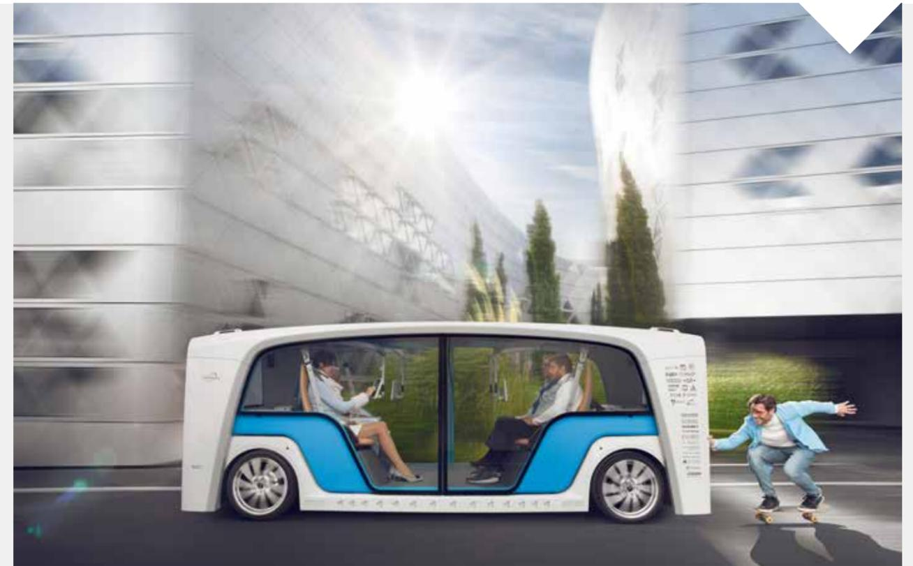
Hochzeit mehr eingehen, sondern getrennte Wege beschreiten. Wie könnte ein solches Szenario aussehen? Alterungsanfällige Komponenten und die IT-relevante Hardware würden in ein eigenständiges Modul eingebracht werden, eine Art „Skateboard“, während das eigentliche nutzenstiftende Modul – auch „Pod“ genannt – nur zeitweise mit dem „Skateboard“ verbunden und somit ständig austauschbar ist.
