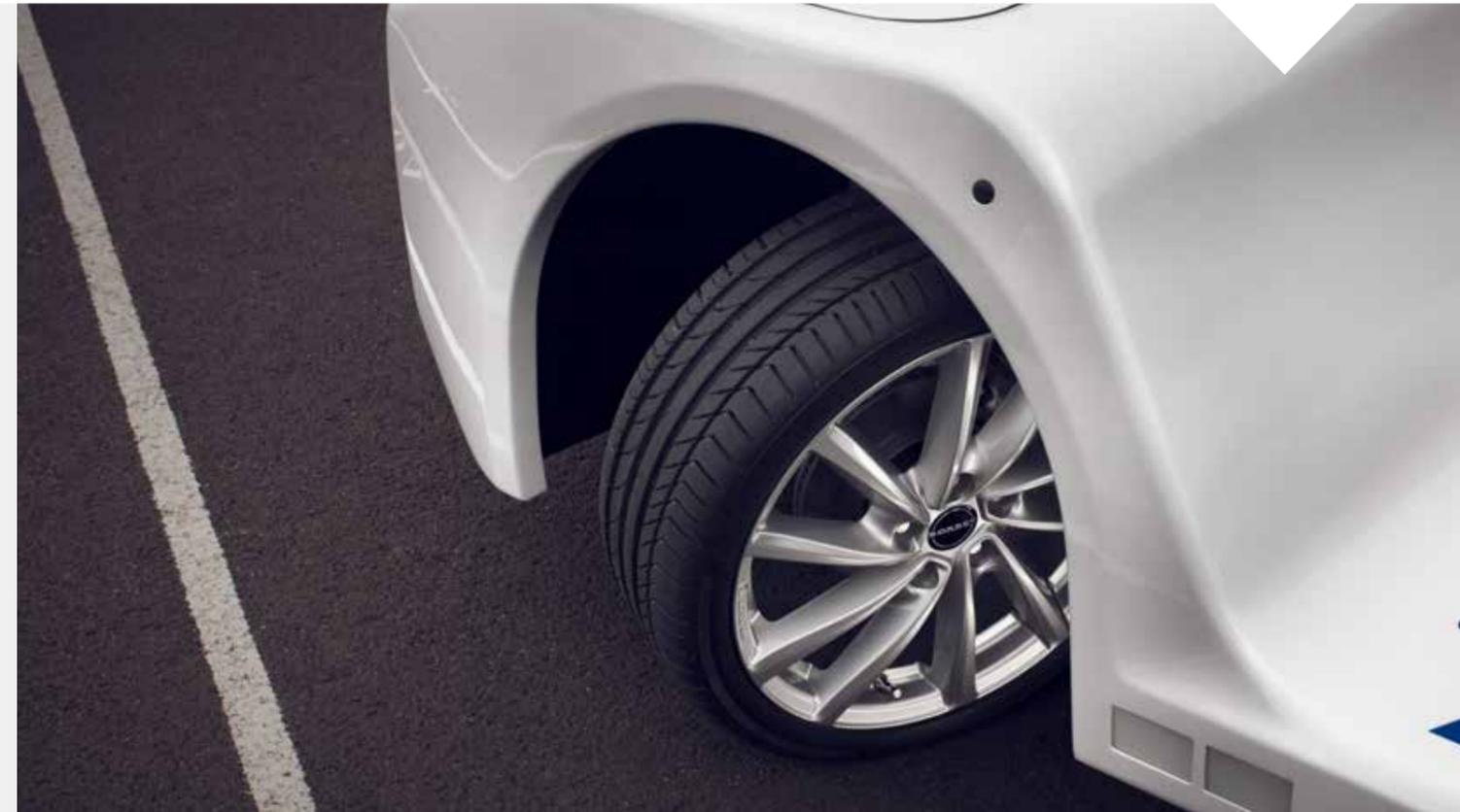
erlaubt Radeinschlagswinkel von bis zu 75 Grad! Zum Vergleich: Übliche Vorderachsen gestatten maximal 50 Grad. Der erweiterte Einschlag durch EasyTurn ist ideal für enge Parklücken und die Fahrt durch enge Gassen, Baustellen, Staus oder Ladezonen. Die für das IDDC modifizierte elektrische Servolenkung von ZF ist eine weitere wichtige Systemvoraussetzung für die Elektrifizierung und für die Automatisierung des Fahrens. Das Gleiche gilt für das im „Snap“ verbaute integrierte Bremssystem von ZF.
